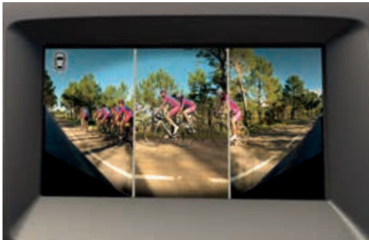
Kamera ułatwiająca parkowanie przodem z szerokim kątem widzenia wyświetla obraz przestrzeni przed pojazdem, ułatwiający wjeżdżanie i wyjeżdżanie przodem w miejscach o ograniczonej widoczności
